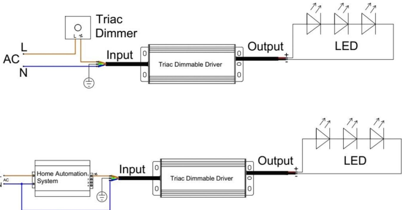
Schéma de connexion de plusieurs convertisseurs / Multiple drivers connecting diagram :
